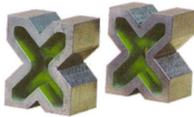
Hochwertiger Grauguss, 4 verschieden große Prismenschnitte 90°, Prismenflächen sind zur Standfläche parallel und paarweise maßgleich innerhalb der Toleranz der entsprechenden Güte.
