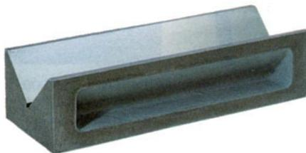
Hochwertiger Grauguss, Prismeneinschnitt 90° ist zur Standfläche parallel und paarweise maßgleich innerhalb der Toleranz der entsprechenden Güte.
